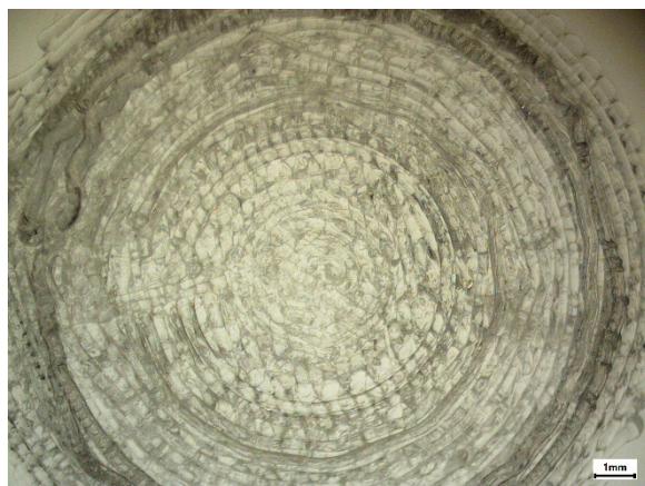
Slika 36. Mikrostruktura (optički mikroskop), uzorak 4, brzina 3D štampe, 60 mm/s
