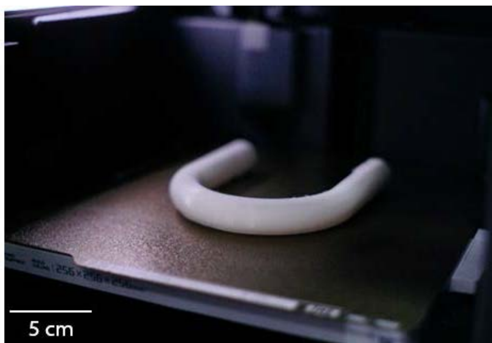
Slika 32. Uzorak zakrivljene cijevi od poliuretana (TPU), proizveden FDM štampanjem
