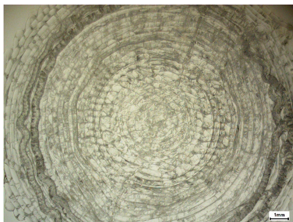
Slika 37. Mikrostruktura (optički mikroskop), uzorak 5, brzina 3D štampe, 70 mm/s
