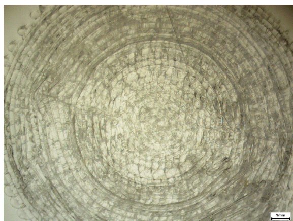
Slika 35. Mikrostruktura (optički mikroskop), uzorak 3, brzina 3D štampe, 50 mm/s
