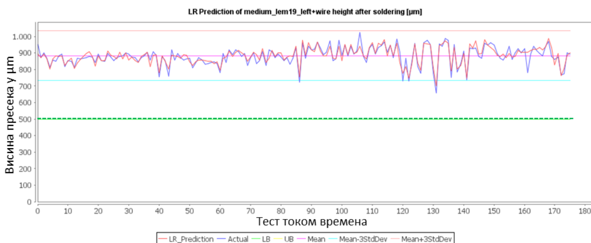
Слика 4.1.8.2-1 Графикони предвиђених и стварних вредности висине проводника за циљну променљиву са највишим R^2 (0.815)
