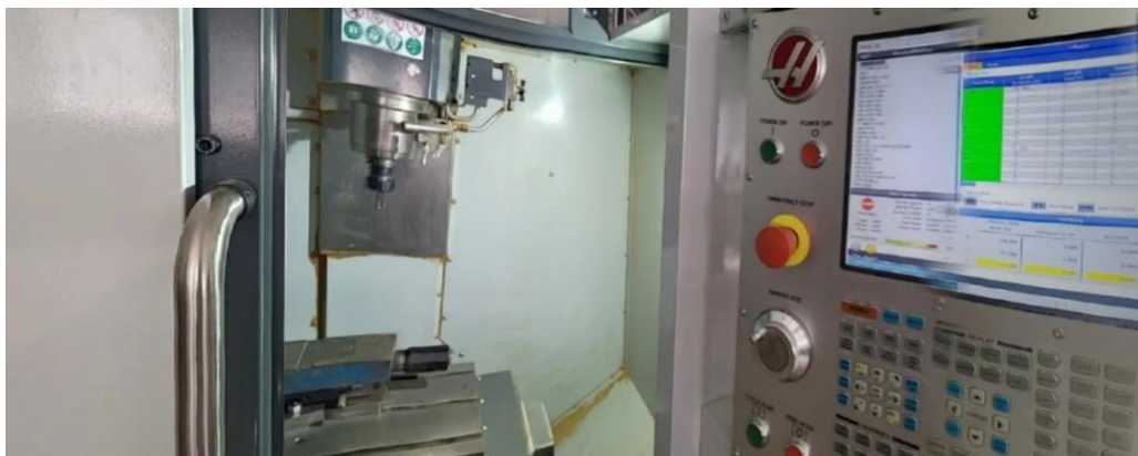
Слика 7. Приказ 360° постављања алата на исправан начин
