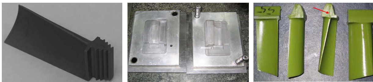
Слика 4.15 Модел лопатице (лево), калупи (у средини) и изливени модели од воска (десно) [Vaezi, 2014]
