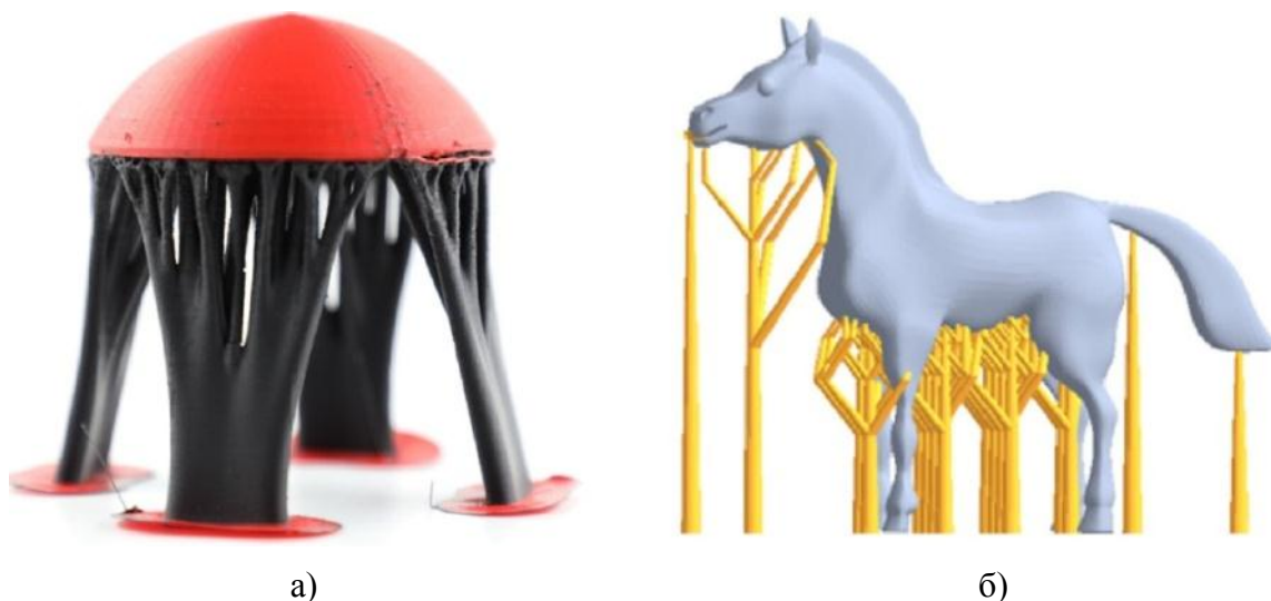
Слика 4.28 Иновативне потпорне структуре: а) тополошки оптимизоване б) потпорне структуре у облику дрвета [Zhu, 2020]
