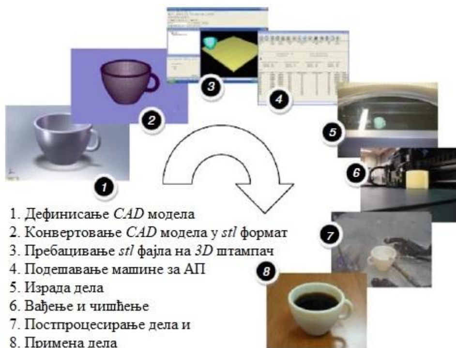
Слика 4.1 Ланац процеса адитивне производње [Gibson, 2021]
