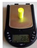
Слика 5.8 Узорци од ABS-а за: а) тест затезања б) тест притискивања и в) током мерења масе узорка пре тестирања
