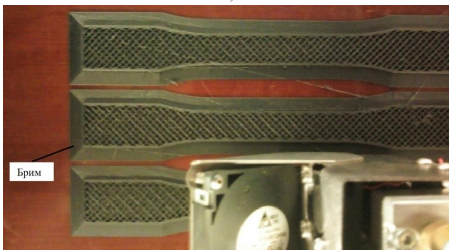
Слика 5.7 Узорци на радном столу штампача направљени од: а) ABS-а и б) Оникса
