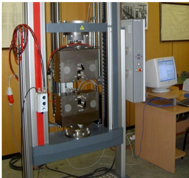
Слика 5.6 Универзална машина за испитивање Zwick/Roell Z100
