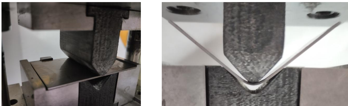
Слика 7.29 Алат од ABS-а на почетку и током процеса савијања
