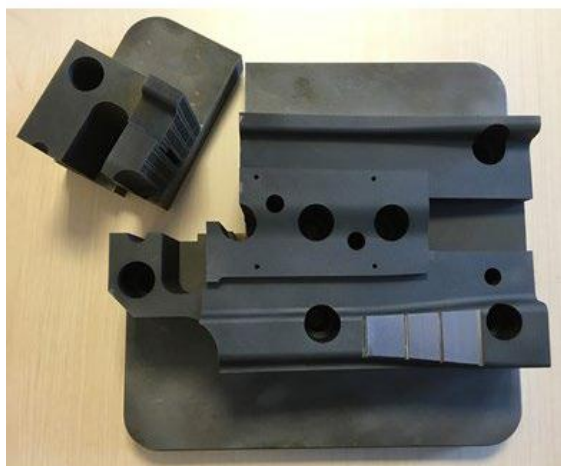
Слика 4.33 Део корачног алата направљен применом адитивне технологије [Asnafi, 2019]
