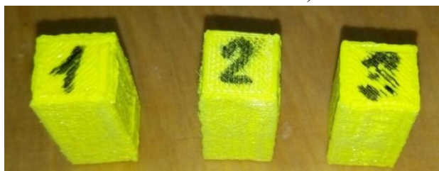
Слика 5.8 Узорци од ABS-а за: а) тест затезања б) тест притискивања и в) током мерења масе узорка пре тестирања
