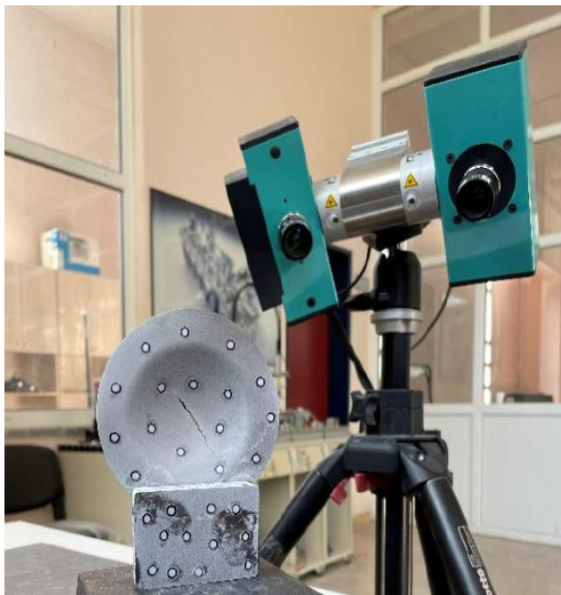
Слика 2.18 Провера тачности делова добијених дубоким извлачењем [Audin, 2022]
