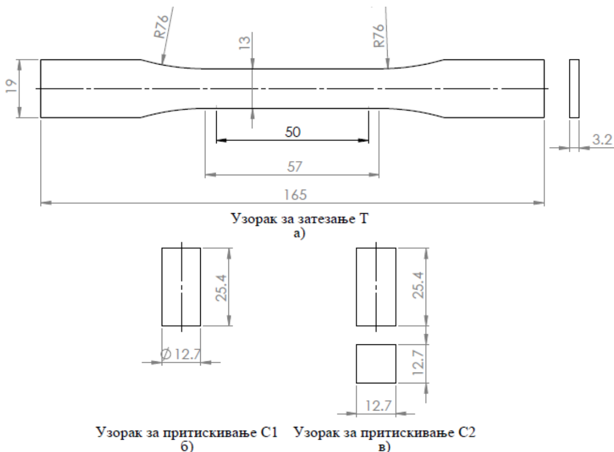
Слика 5.4 Облик и димензије узорака за: а) тест затезања Т б) тест притискивања са цилиндричним узорком C1 в) тест притискивања са узорком у облику квадрa C2
