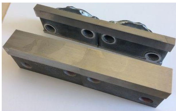
Слика 4.32 Тополошки оптимизован алат за просецање [Asnafi, 2019]
