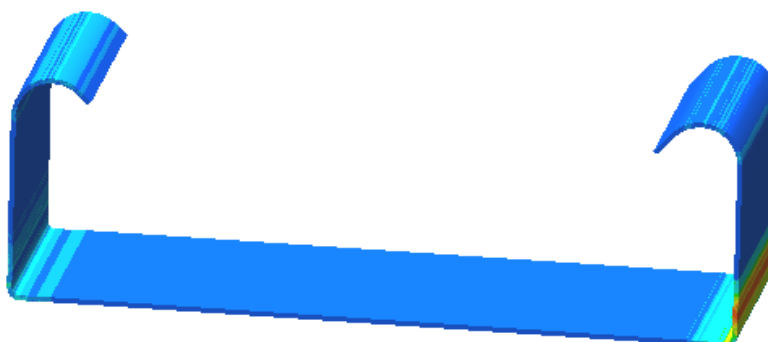
Слика 8.7 Резултати нумеричке симулације за савијени део: а) ефективна пластична деформација дела и б) ефективни напон
