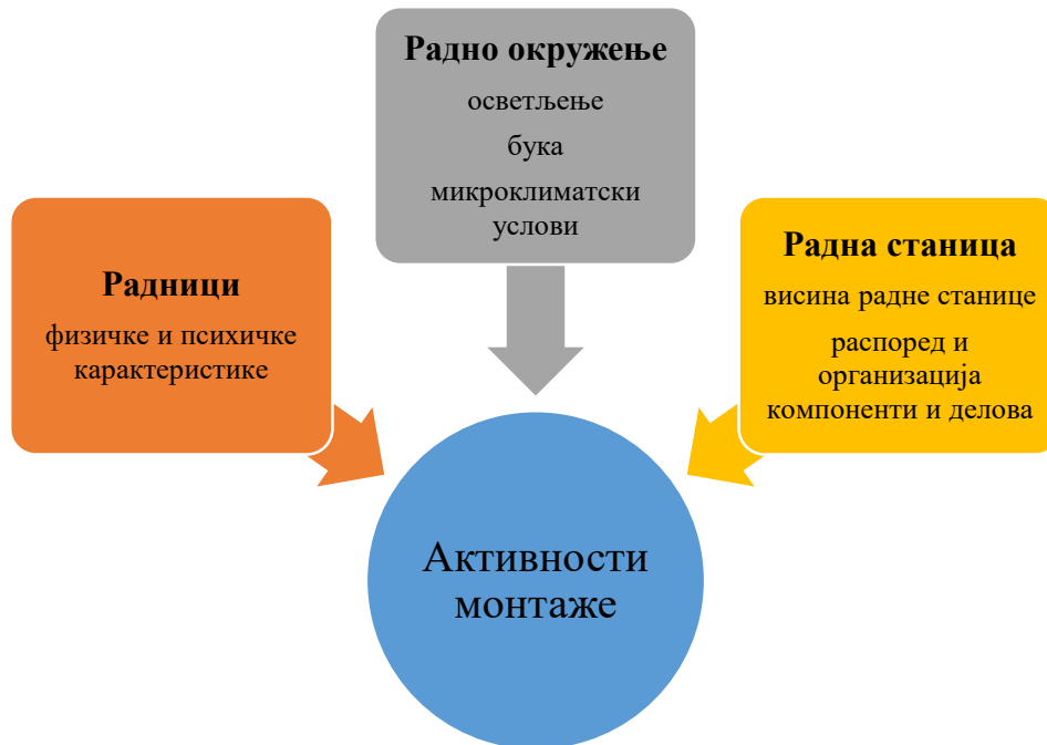
Слика 5.23 Фактори који утичу на процес монтаже (прилагођено према Szombathyová и Kováč, 2010)
