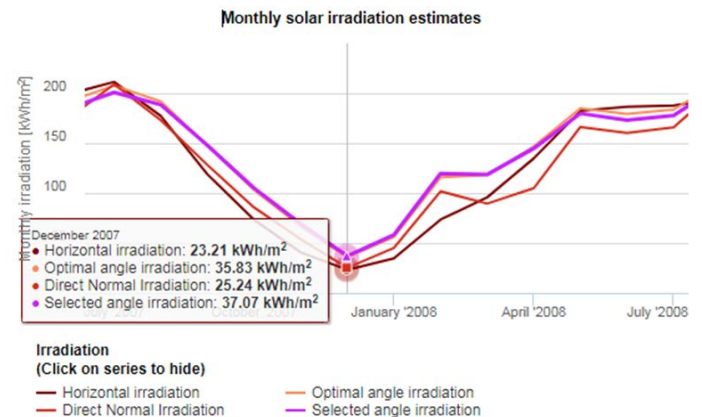
Slika 9. Detaljni prikaz mesečnih solarnih iradijacija za lokaciju Bezdan za 2007/2008.
