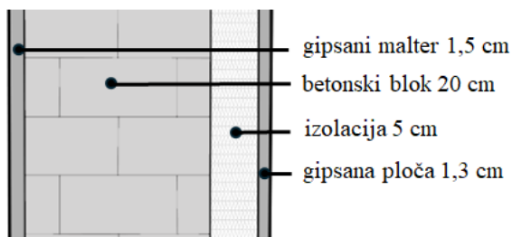
Slika 8. Izolovani betonski zid [5]
