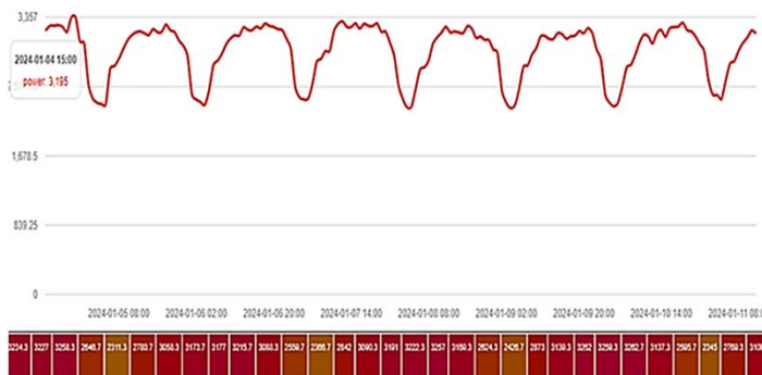
Slika 3. Vremenski dijagram aktivne snage (kW) i utrošene električne energije u određenim vremenskim intervalima (kWh) radio bazne stanice „Kumane“
