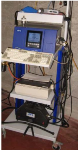
Slika 1. Uređaj za merenje emisije AVL DiCom 4000
