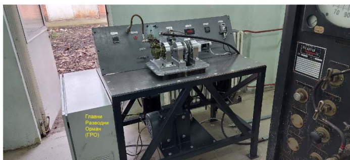
Slika 4. Izgled realizovanog ispitnog stola za ispitivanje kompresorskih motora
