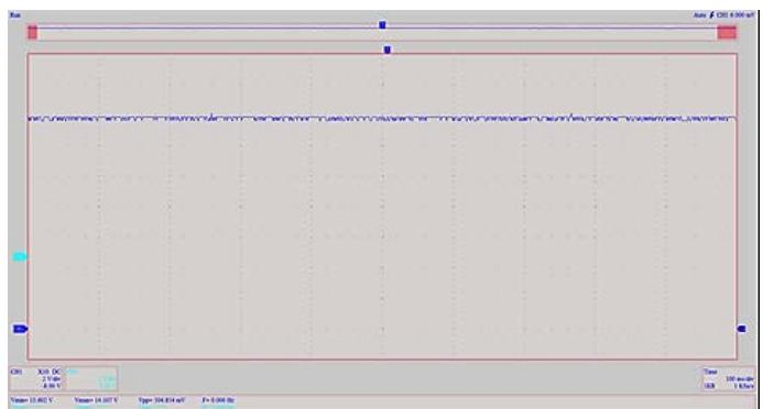
**Slika 16.** Talasni oblik izlaznog napona pri opterećenju 30 W, osciloskop podešen na 2 V/div, 100 ms/div,  $U_{IN} = 36 \text{ V}$
