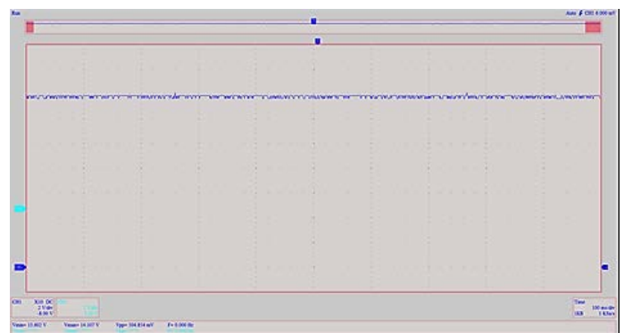
Slika 16. Talasni oblik izlaznog napona pri opterećenju 30 W, osciloskop podešen na 2 V/div, 100 ms/div, U_{IN} = 36 V
