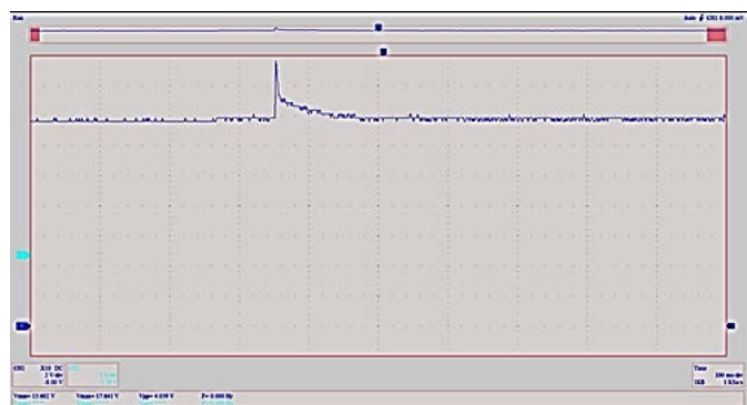
Slika 19. Talasni oblik izlaznog napona pri rasterećenju sa 140 W na 30 W, osciloskop podešen na 2 V/div, 100 ms/div, U_{IN} = 36 V
