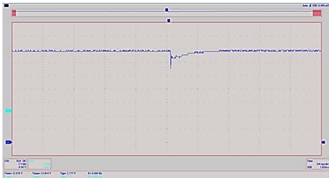
Slika 18. Talasni oblik izlaznog napona pri promeni opterećenja sa 30W na 140W, osciloskop podešen na 2 V/div, 100 ms/div, U_{IN} = 36 V
