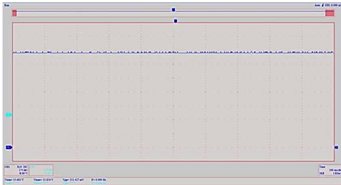
Slika 17. Talasni oblik izlaznog napona pri opterećenju 140 W, osciloskop podešen na 2 V/div, 100 ms/div, U_{IN} = 36 V
