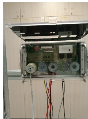
Slika 3. Pomoćno visoko precizno brojilo oznake C na ispitnoj stanici u Kontrolnom telu u EMS AD, korišćeno u ogledu radenom radi izračunavanja proširene merne nesigurnosti mernog sistema
