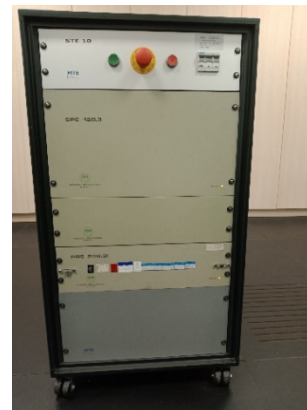
Slika 4. Zajednički orman za napojnu jedinicu ispitne stanice i etalon brojilo klase tačnosti 0,02 za aktivnu električnu energiju u Kontrolnom telu u EMS AD
