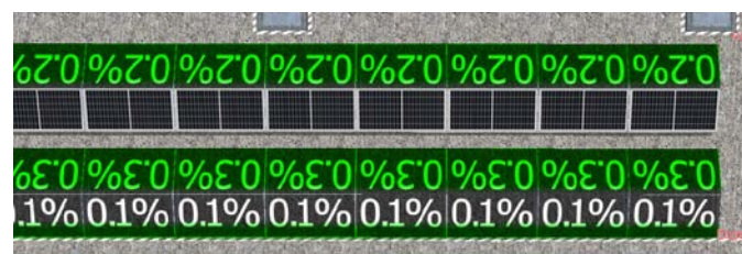
Slika 20. Prikaz uticaja senke na solarne panele na ravnom delu krova
