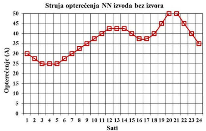
Slika 1. Dijagram struje niskonaponskog (NN) izvoda bez izvora
