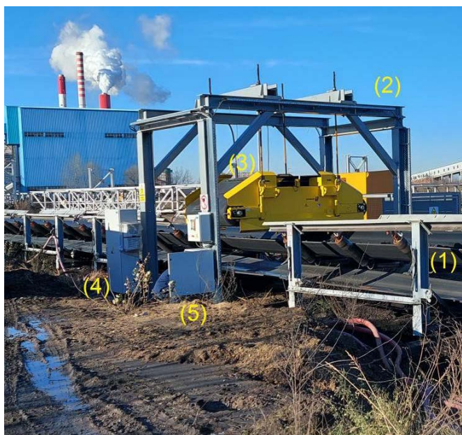
Slika 10. Prikaz dispozicije podstanice elektromagnetnog separatora
