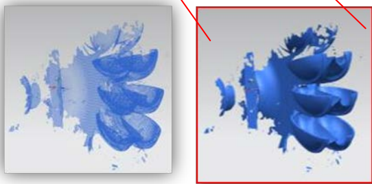
Slika 5. Proces digitalizacije radnog kola Peltonove turbine
