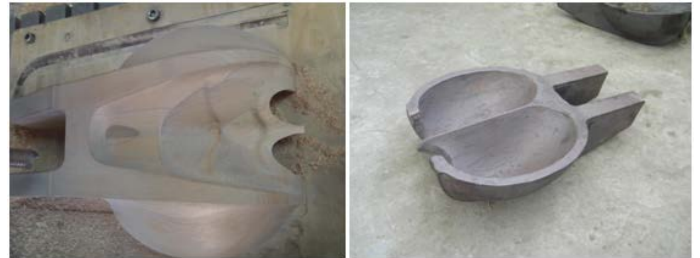
Slika 10. Drveni model i odlivena lopatica
