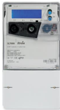
Slika 1. Često korišćeno brojilo električne energije u industriji i transformatorskim stanicama i razvodnim postrojenjima, klase 0,2 S ili 0,5 S za aktivnu električnu energiju sa devetocifarskim ekranom, koje se pravi za konstantu 10000 imp./kWh za brojila za indirektni priključak preko mernih transformatora [5].
