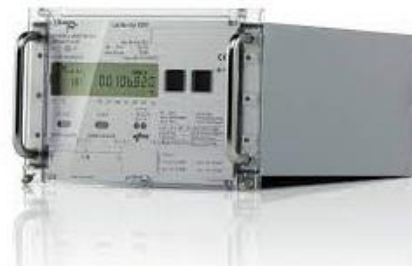
Slika 8. Brojilo električne energije visoke preciznosti merenja, klase 0,2 S ili 0,5 S za aktivnu električnu energiju sa osmocifarskim ekranom [7]. Obično se koristi za merenje električne energije u prekograničnoj razmeni
