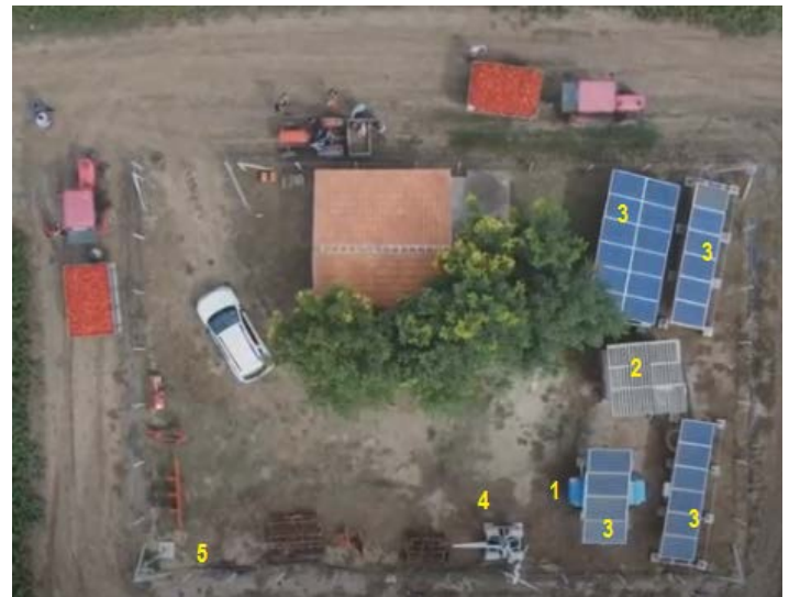
Slika 17. Realizacija hibridnog sistema napajanja banke na poljoprivrednoj parceli Smart Land - „Belegiš“ sa pojedinim funkcionalnim celinama: (1) baterijska banka, uređaji energetske elektronike i merno-regulacioni deo, (2) prostorija za smeštaj razvodnog ormara pumpnog agregata sa frekventnim regulatorom i razvodnog ormara DEA, (3) sistem solarnih panela 12x250W i 4x350W, (4) montažni stub sa VG snage 500W, (5) meteorološka stanica
