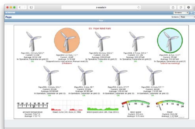
Slika 5. Z-SCADA monitoring sistem za vjetrogeneratore
