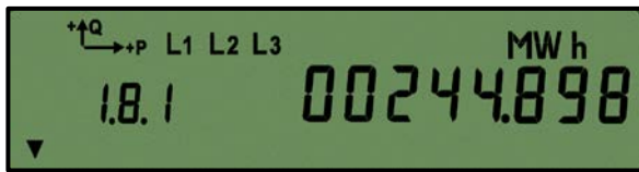
Slika 5. Prikaz ekrana brojila B , sa slike 2.b), klase tačnosti 0,2 S , na kome je prikazana trenutna vrednost aktivne električne energije u prvoj tarifi sa rezolucijom pokazivanja energije na tri decimalna mesta u megawatčasovima.
