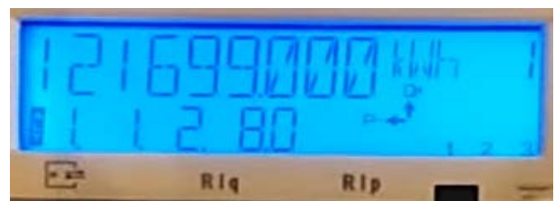
Slika 3. Ekran brojila A , sa slike 2.a), klase tačnosti 0,2 S, na kome je prikazana trenutna vrednost ukupne aktivne električne energije za povratni smer energije sa rezolucijom prikazivanja energije na tri decimalna mesta u kilovatčasovima.
