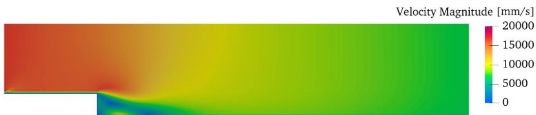
Слика 9. Поље брзина у програму PAKF-TurbuleInt након t=100s
