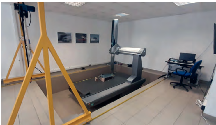
Слика 11.34 СММ контактна савремена мерна трокоординатна машина
