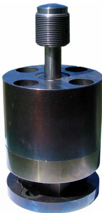
Слика 7. Фотографски приказ реализованог уређаја екстремно високог притиска.
